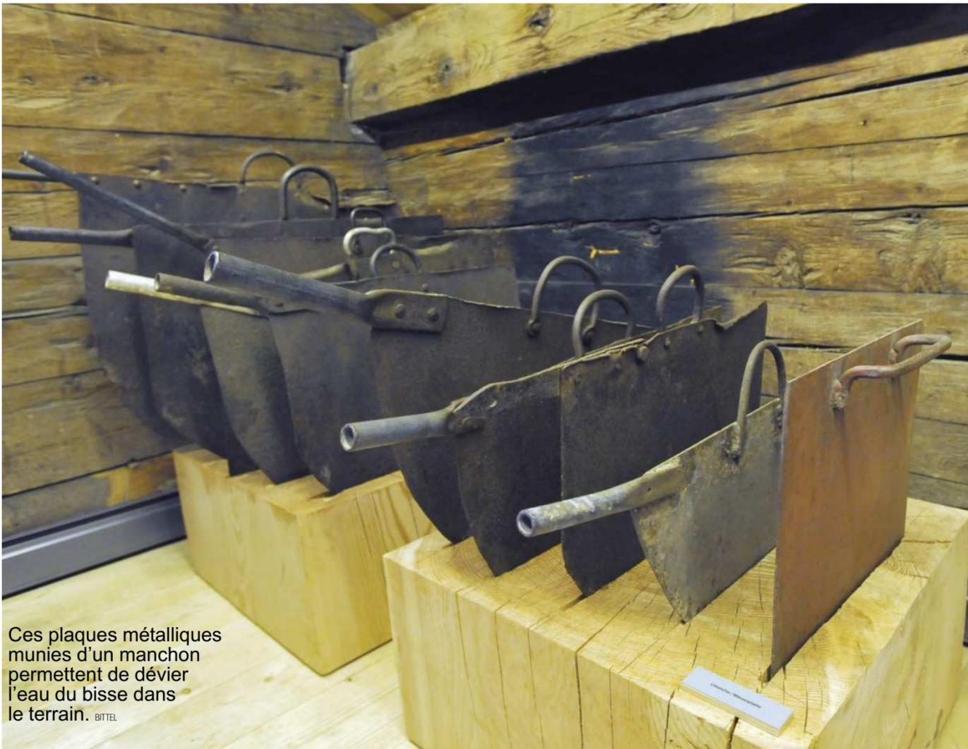
Ces plaques métalliques munies d'un manchon permettent de dévier l'eau du bisse dans le terrain. BITTEL
