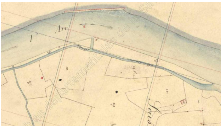
Figure 23 : Canal de sécurité sur un canal d'arrosage à Sollières, extrait du PCF, section G, feuille 2, 1893
