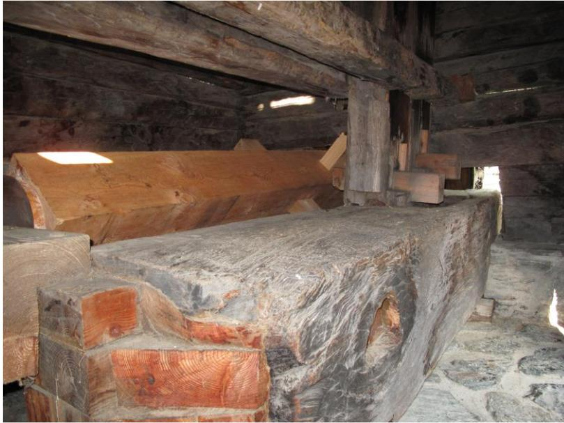
Fig. 15. L'arbre à cames et les pilons (photo C. Moser)
