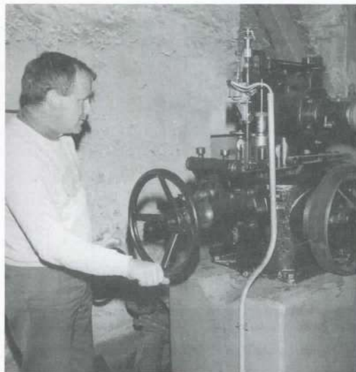
Prior Klaus Sarbach stellt die Frequenz der kleinen Stromturbine ein, die schon 1906 unter Prior Moritz Borter in Betrieb genommen worden ist.
