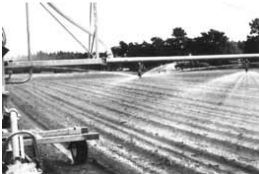
FIGURE 9.3 - Mini-diffuseurs en cercles complets et demi-cercles.
