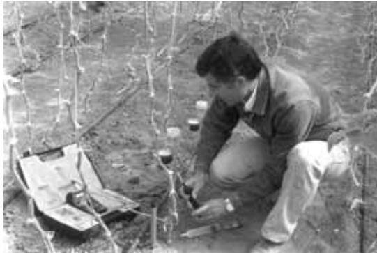
FIGURE 3.41 - Mesure directe des solutions du sol au moyen d'un conductivimètre et extracteurs installés dans un champ.
