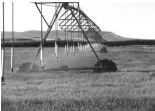
FIGURE 10.3 - Tubes suspendus avec mini-diffuseurs.
