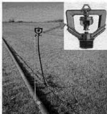
FIGURE 3.27 - Micro-asperseur avec buse rotative (spinner).
