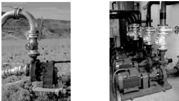
FIGURE 3.47 - Gauche: pompe rotodynamique entraînée par un tracteur Droite: unité de pompage constituée de pompes rotodynamiques en parallèle.
